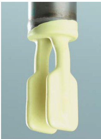
Cambio de frecuencia debido a adherencias (alarma de mínimo)
