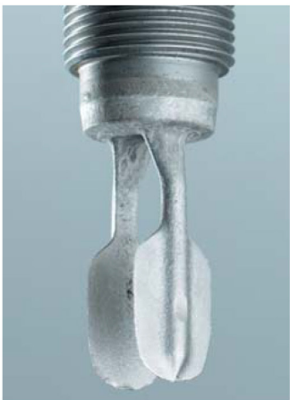
Cambio de frecuencia por corrosión (alarma de máximo)
